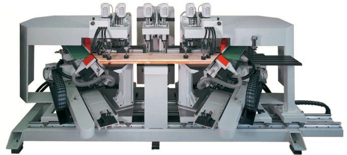
Der Sargkonfigurator bietet minimale Rüstzeiten, die Maschine mit geringer Aufstellfläche dafür maximalen Output. Mit der DAS-U präzise Sägen, Nuten und Bohren in der Rekordzeit von nur 10 Sekunden.
