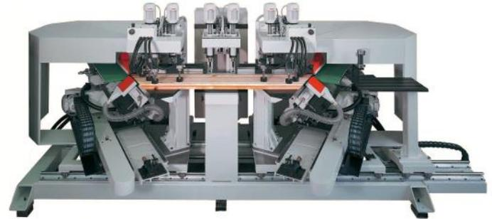
Der Sargconfigurator bietet minimale Rüstzeiten, die Maschine mit geringer Aufstellfläche dafür maximalen Output. Mit der DAS-U präzise Sägen, Nuten und Bohren in der Rekordzeit von nur 10 Sekunden.
