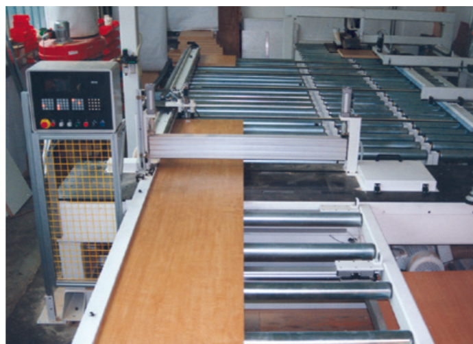
Stacja „3 w 1”: piła, frez i wiertarka
