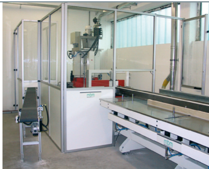
Stacja „3 w 1”: piła, frez i wiertarka
